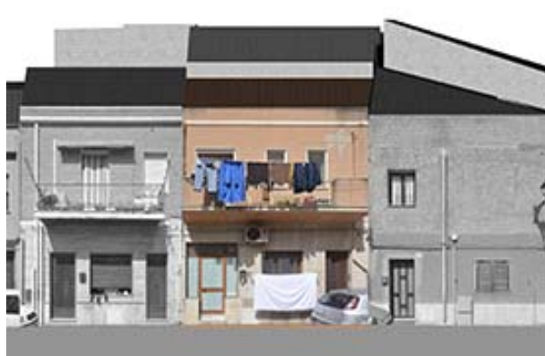
Profilo stato attuale (fotoraddrizzamento)
