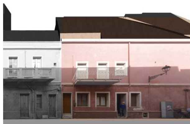
Profilo stato attuale (fotoraddrizzamento)
