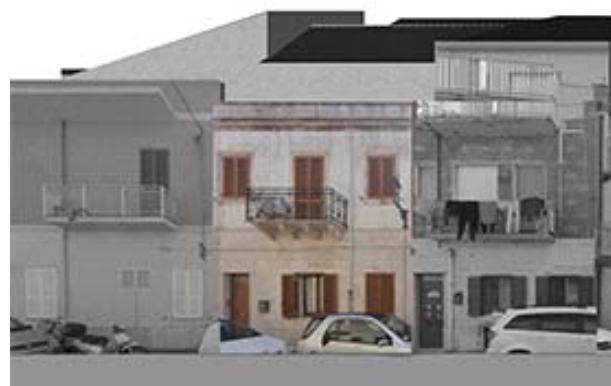
Profilo stato attuale (fotoraddrizzamento)
