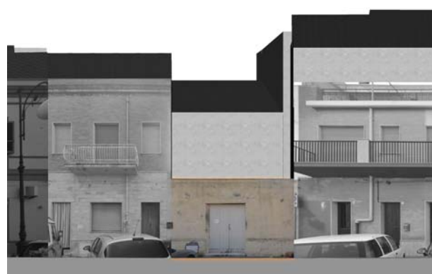
Profilo stato attuale (fotoraddrizzamento)
