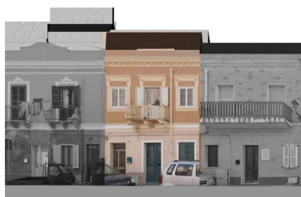
Profilo stato attuale (fotoraddrizzamento)
