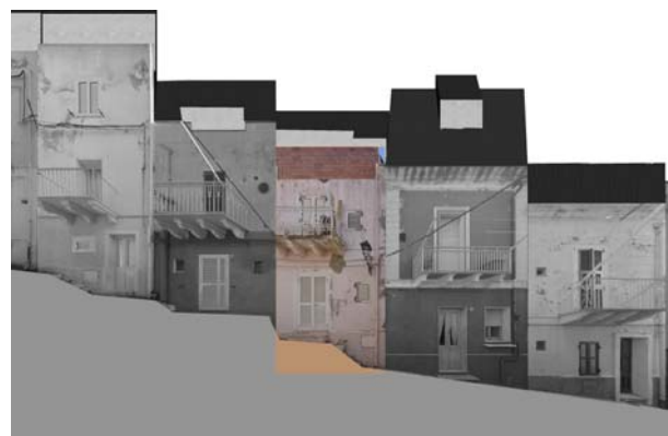
Profilo stato attuale (fotoraddrizzamento)
