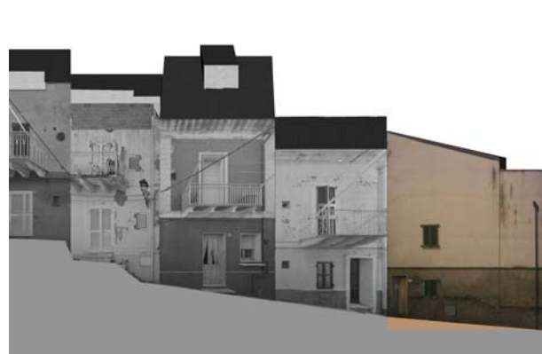
Profilo stato attuale (fotoraddrizzamento)
