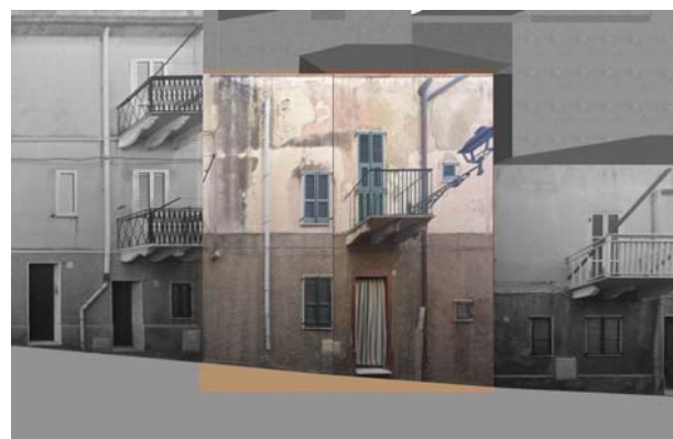
Profilo stato attuale (fotoraddrizzamento)
