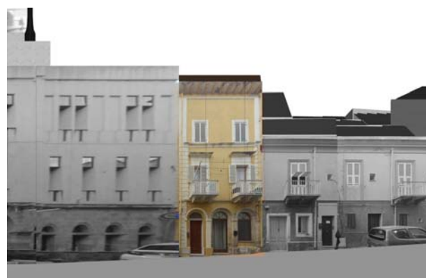
Profilo stato attuale (fotoraddrizzamento)
