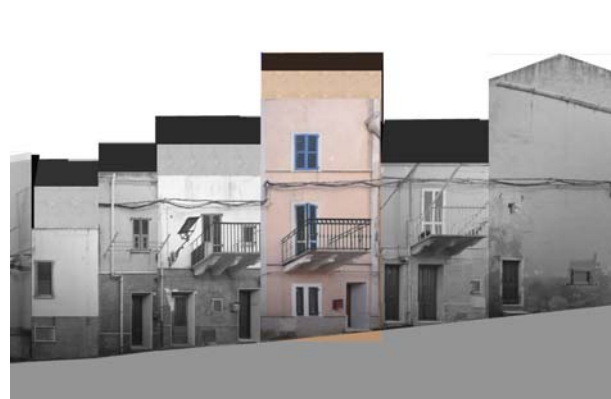
Profilo stato attuale (fotoraddrizzamento)
