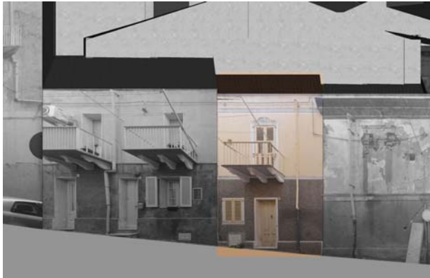
Profilo stato attuale (fotoraddrizzamento)
