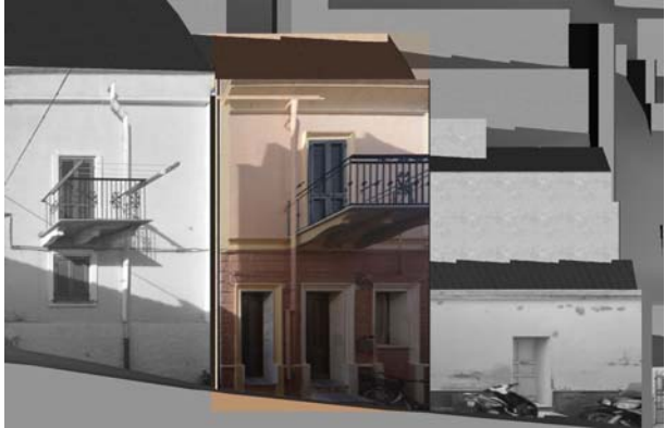
Profilo stato attuale (fotoraddrizzamento)
