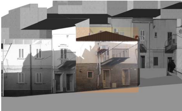
Profilo stato attuale (fotoraddrizzamento)
