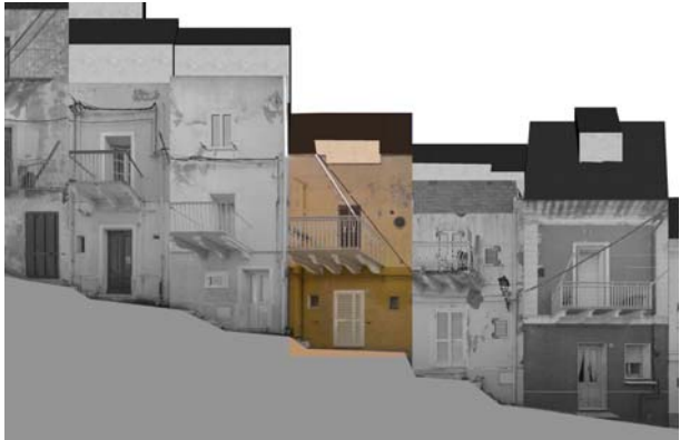
Profilo stato attuale (fotoraddrizzamento)
