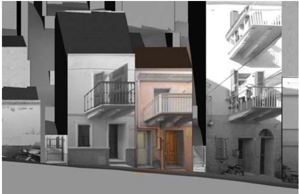
Profilo stato attuale (fotoraddrizzamento)
