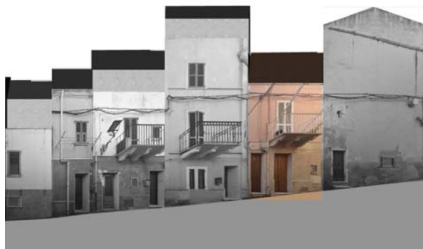
Profilo stato attuale (fotoraddrizzamento)
