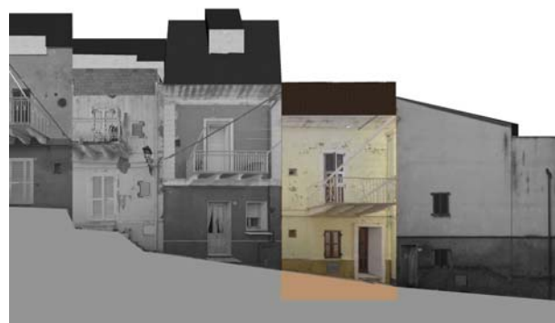
Profilo stato attuale (fotoraddrizzamento)
