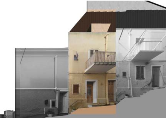
Profilo stato attuale (fotoraddrizzamento)
