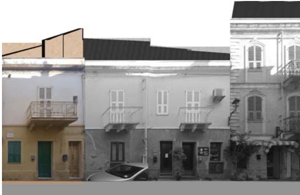
Profilo stato attuale (fotoraddrizzamento)
