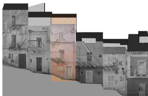
Profilo stato attuale (fotoraddrizzamento)
